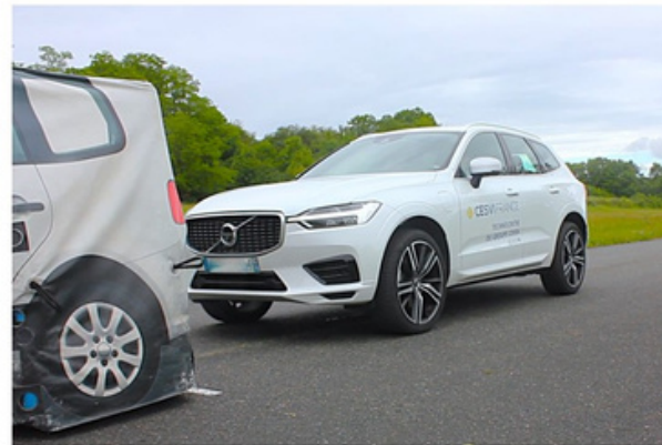
Test de freinage d'urgence au Cesvi en 2019. Le Technocentre sensibilise depuis longtemps les acteurs de la réparation sur l'importance du recalibrage pour la sécurité. ©J2R/NG
